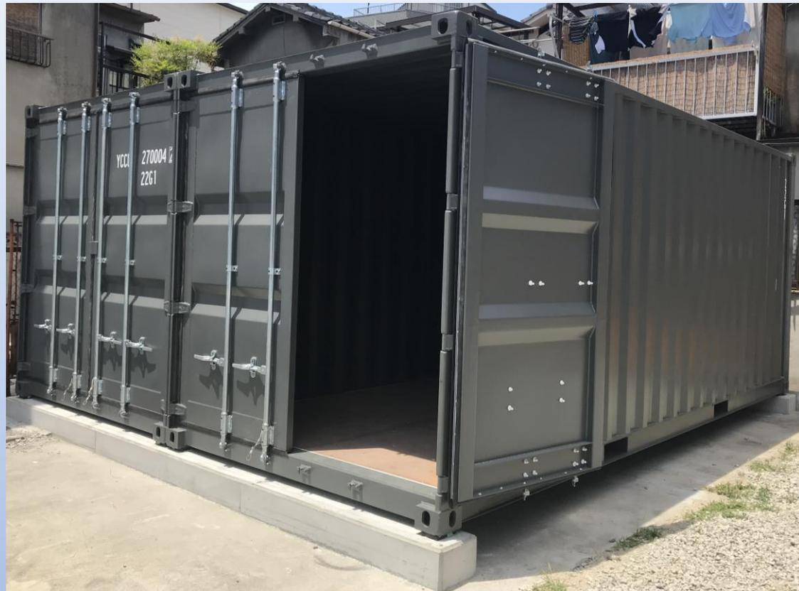
【サイズ】 外寸：幅3,658mm×奥行2,438mm×高さ2,647m(20ft×2台)
